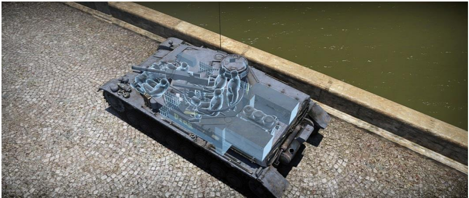
Modules et équipages dans le PzKpfw IV Ausf.C
