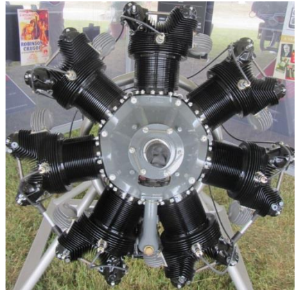
Moteur radial Continental R-670 alimentant le M2 - assez rapide pour se sortir des bûches
