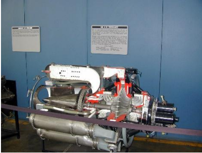
Un turborreactor Whittle W.1/W.2B de la General Electric as the J31 (I-16), nótese el tamaño del compresor centrífugo, la admisión, a la derecha del motor.
