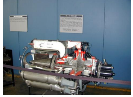
Whittle W.1/W.2B turbojet. Sağ taraftaki büyük giriş ağzı çarkına dikkat edin
